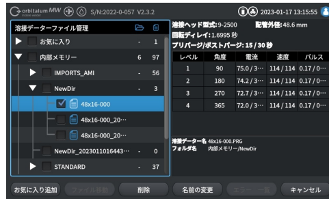
溶接条件の管理画面はフォルダツリー構造 （要素別にまとめておけば条件検索は容易）
