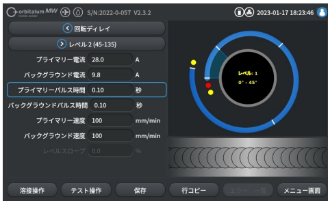
溶接条件入力画面 （ロータリーダイヤルだけの入力も可能）
