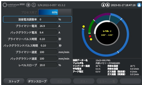
溶接実行中の画面表示 （溶接シーケンスグラフィックをアニメーション表示）
