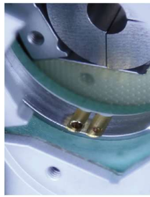
電極径は 1.0mm / 1.6mm の使用が可能
