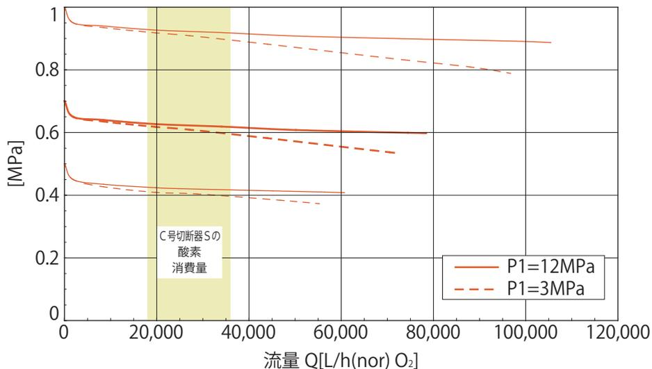
※C号切断器の酸素消費量は酸素流量 18,000 ~ 36,000L/h(nor) を表示しています。
