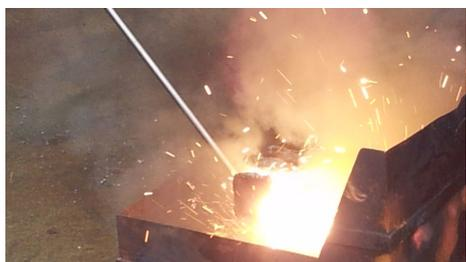
一般溶断用調整器及び酸素ホースφ9 使用時の火炎
