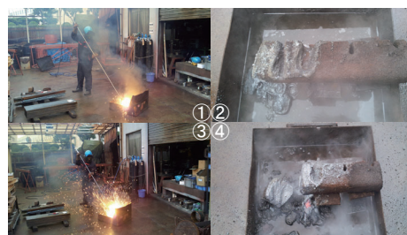
①・② 一般工業用調整器及び酸素ホースφ9 使用時 ③・④ NT50-LA 及び酸素ホースφ12 使用時
