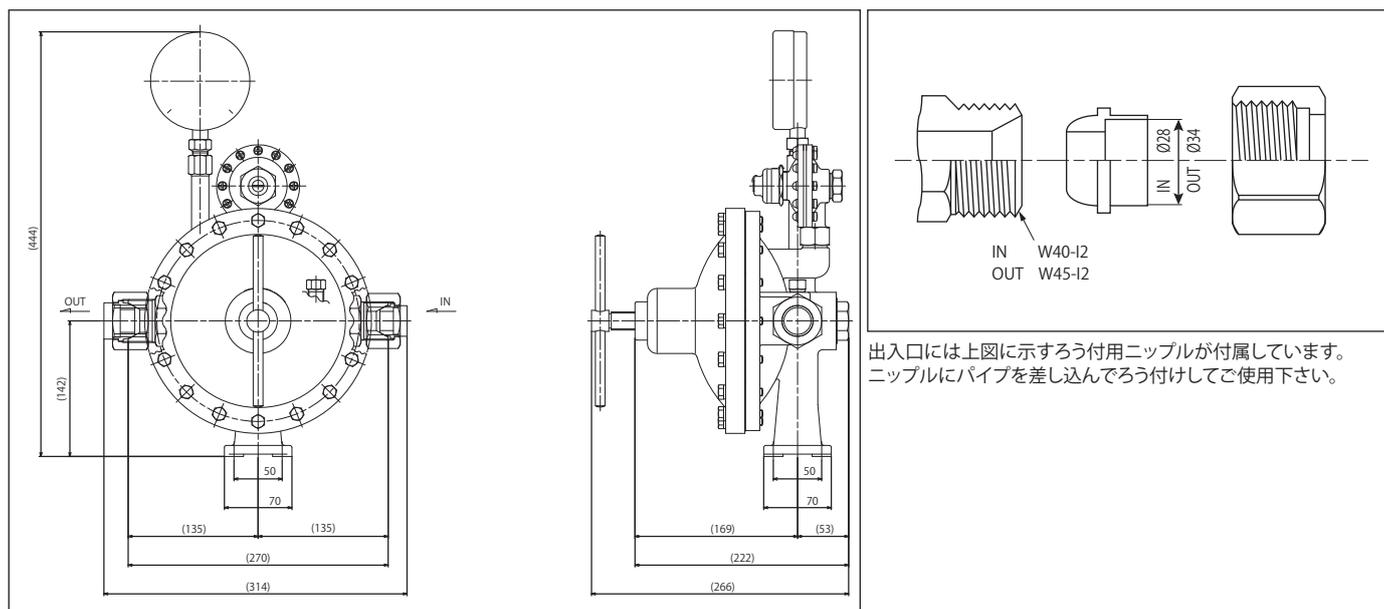
出入口には上図に示する用ニップルが付属しています。ニップルにパイプを差し込んでろう付けしてご使用下さい。
