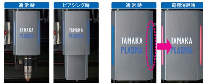
スパッタ飛散防止機構を搭載。ピアシング時のスパッタ飛散を抑制します。
