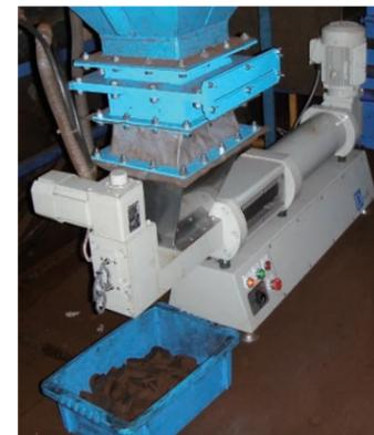
集塵機に集められたプラズマヒュームをすみやかに固形化・減容する装置です。本機ではモータを駆動源にしているため、お客さまには電源をご用意いただくのみで効率よくご導入いただけます。
