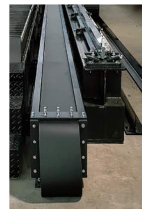
H鋼架台走行レール
