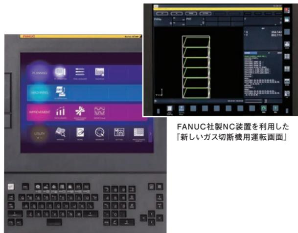
FANUC社製NC装置を利用した「新しいガス切断機用運転画面」
