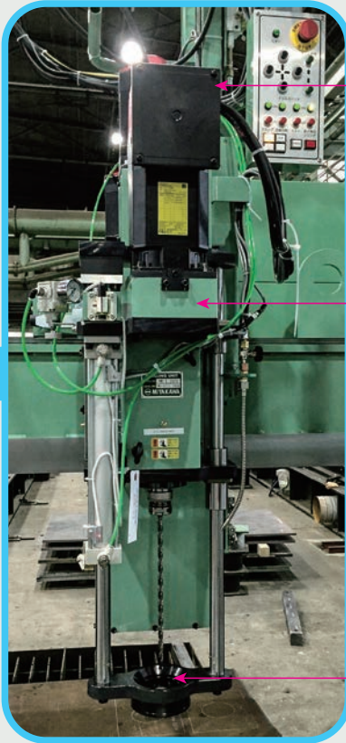
上下昇降ユニット FANUCモータにより 速度・位置制御可能
