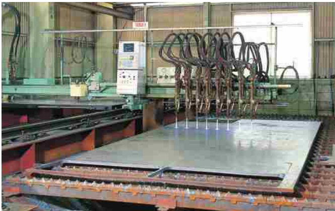
オプション：左勝手仕様、自動昇降装置、自動点火装置、散水装置、RTQ-15、切断吹管8本搭載
