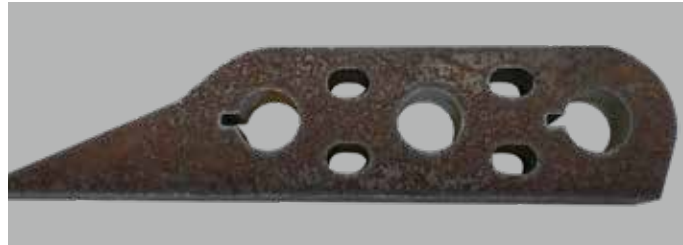
高炉材 SS400 鋳材板厚25mm
