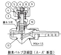
酸素バルブ詳細図（A-A' 断面）
