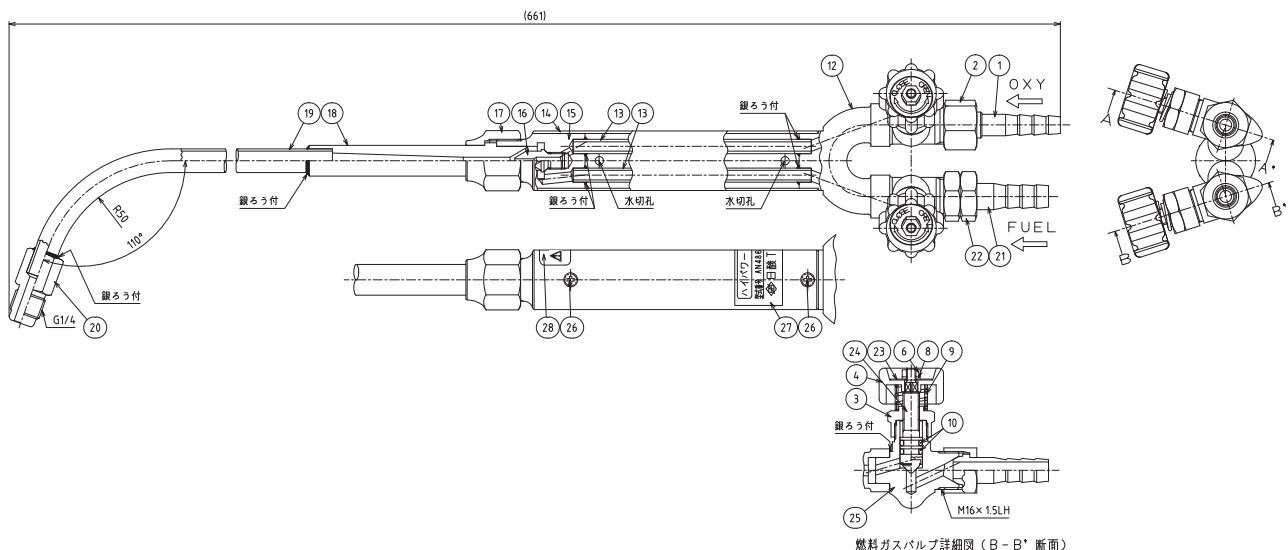
燃料ガスバルブ詳細図（B-B' 断面）
